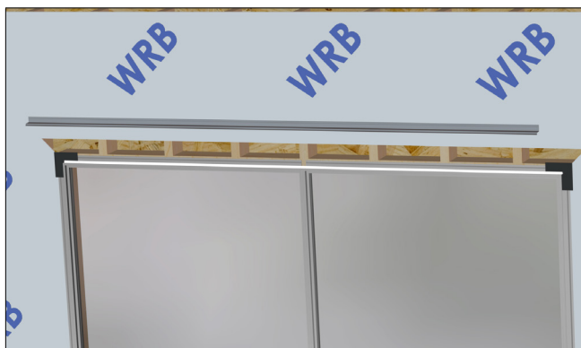
Fig. 3. Después de aplicar sellador en todas partes que entre en contacto con la tapa de goteo, coloque la tapa de goteo en la parte superior del marco y asegúrese de que esté al ras con la aleta de la uña y el marco.
