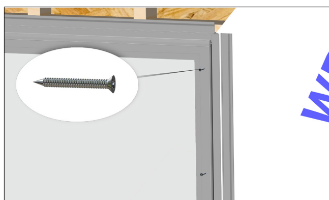
Fig 8. Fije todas las aletas de montaje a la estructura utilizando tornillos autorroscantes #8 de 1 1/4 pulgadas.
